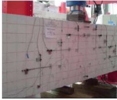
شكل (٥) اختبار القص للخرسانة المسلحة عند 128kipes (57.142 ton) (يمين) grade 60 steel (يسار) MMFX المصدر: http://rebar.ecn.purdue.edu/ect/links/technologies/civil/mmfx.aspx
