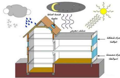
شكل (1) قطاع توضيحي لمكونات الغلاف الخارجي للمبنى
