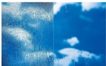
شكل ٦ الفرق بين الزجاج النانوي ذاتي التنظيف و زجاج عادي المصدر: http://www.syr-res.com/article/8141
