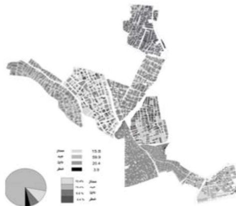
شكل رقم(13) توضح حالات المباني بالمنطقة.
