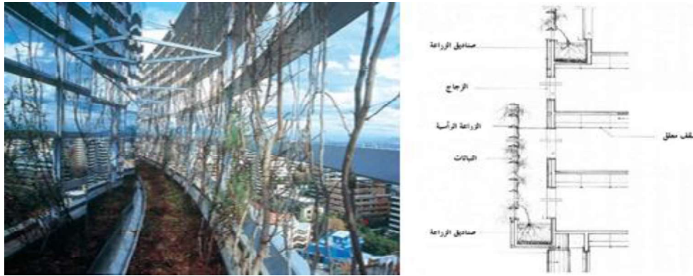
شكل18. يوضح التفاصيل في قطاع الزراعة الرأسية و شكل صندوق الزراعة.[20]
