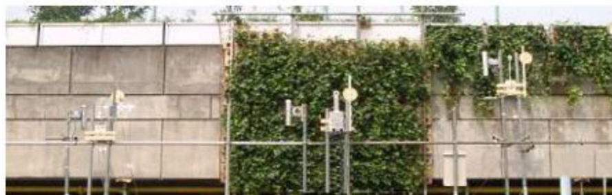
شكل 11. تجربة لمعرفة أختلاف درجات الحرارة عبر الواجهات بالنباتات وبالخرسانة. [2]
