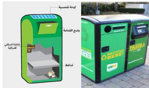
(شكل 21): يوضح مكابس القمامة التي تعمل بالطاقة الشمسية، مبيّنًا بها مكوناتها المختلفة. [33]
