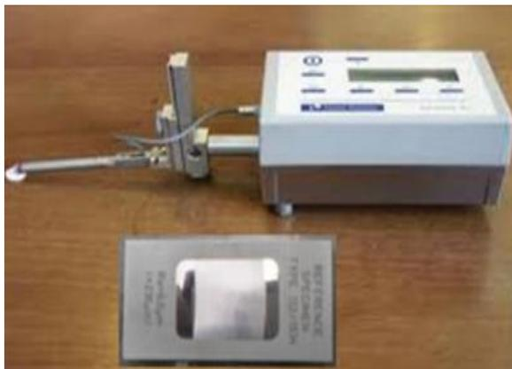
Fig. 2: Surtronic 3+ stylus profilometer
